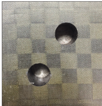
Orificios barrenados con herramientas de diamante policristalino
