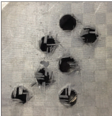
Orificios barrenados con inserto de broca CVD
