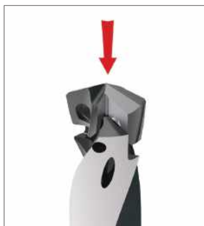
Paso 2: Deslizar el inserto en la base de precisión ubicando la cavidad en el cuerpo de broca. No se debe girar, rotar o enroscar el inserto para trabarlo. La cavidad del inserto y las almohadillas de localización del inserto garantizan repetibilidad y ajuste óptimos.
