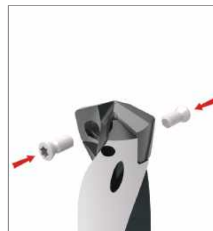
Paso 3: Aplicar una cantidad generosa de E-Z Break® (se suministra en el envase) en los tornillos TORX® Plus incluidos. Ajustar los tornillos TORX Plus al valor del par de torsión recomendado que se especifica en el catálogo para cada serie. Hay un destornillador Torx con torquímetro disponible para garantizar que se aplique el par de torsión adecuado.
