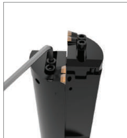
Paso 3: Ajuste los tornillos de montaje en el cartucho a 11-14 pie-libra (15-19 N-m).
