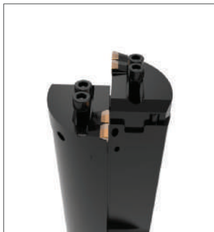
Paso 1: Aflojar los tornillos de montaje en ambos cartuchos.
