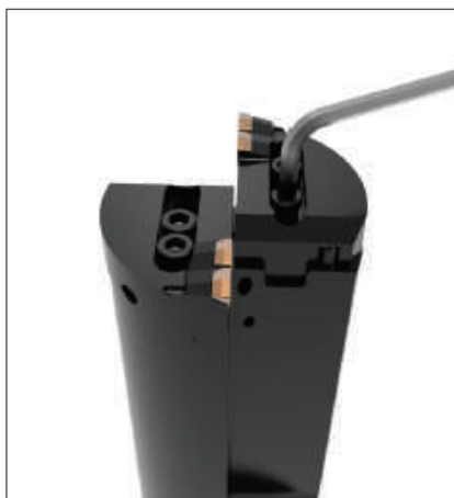
Paso 5: Ajuste los tornillos de montaje en el cartucho a 11-14 pie-libra (15-19 N-m).
