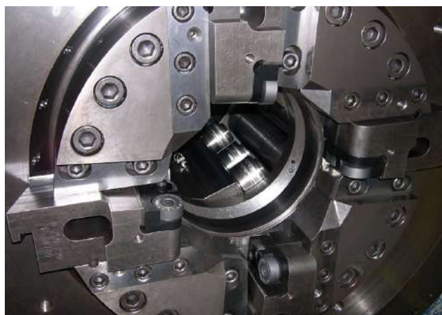
Cabezal de descortezado para barras - Ø 15 a 350 mm
