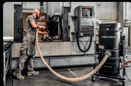
Limpieza de virutas metálicas de máquina CNC
