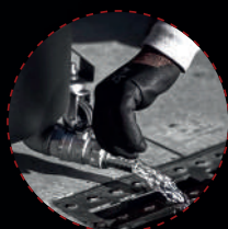
Descarga manual por gravedad
