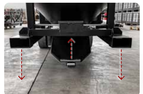
Sistema de cierre de puertas por presión en el suelo
