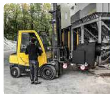
Sistema de descarga basculante
