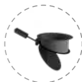
Válvula de descarga por contrapeso
