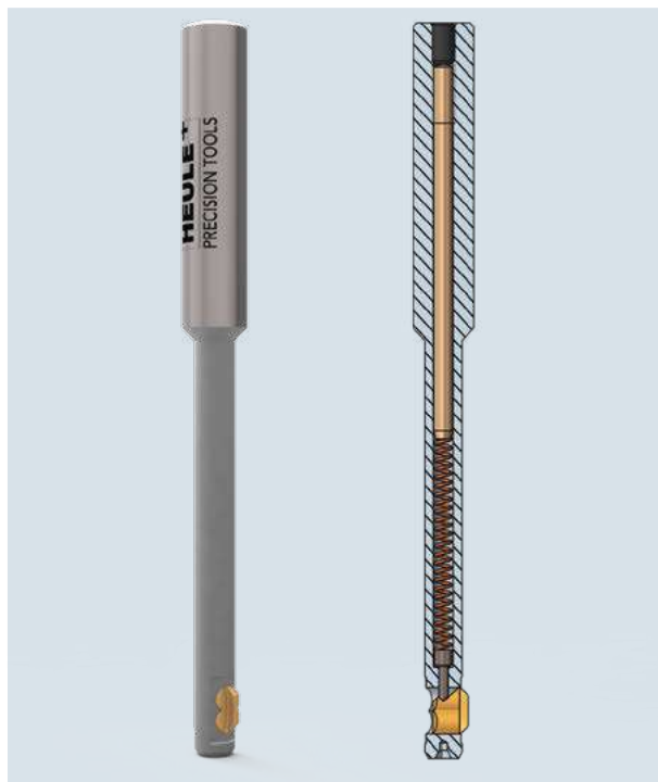
Imagen: SNAP5 - La denominada geometría "B" de la cuchilla es más compleja en cuanto a la fabricación. Sin embargo, su capacidad de guiado optimizada justifica este diseño para este tamaño de herramienta.
